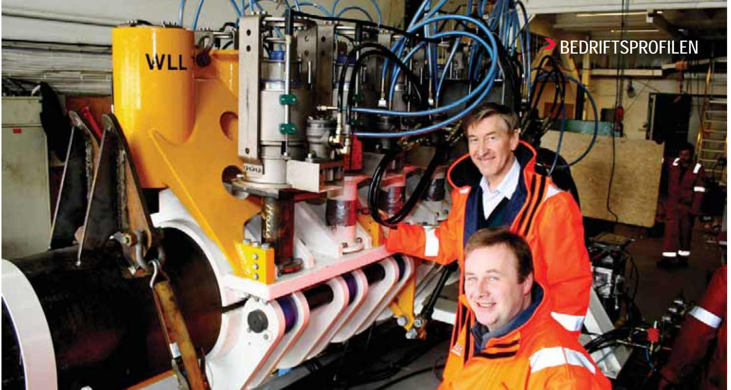
En av Imenco sine 'Smart Solutions' produkt. Hot Tap Tee Clamp, produsert for oppdragsgiver StatoilHydro. Designet brukes for ekstern installasjon på gassrør under vann uten behov for dykkere. Foran Odd Einar Lindøe, senior engineer og Arne Kinn, engineering manager i Imenco.
