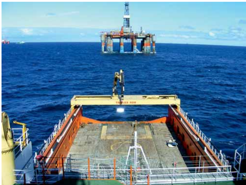
Sammen med Solstad Technology og Triplex konstruerte Karmøy Skipsconsult verdens første multi deck handler for sikker ankerhåndtering.
