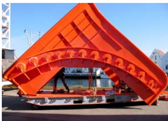
Slipway produsert i aluminium.
